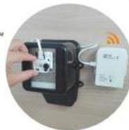
**BelSenso FM432e** est un dispositif universel de télé-relève des compteurs électriques. S'interfaçant avec le **réseau bas débit LoRa**, il permet en quelques minutes d'installation d'être informé sur son niveau de consommation d'électricité. Une solution incontournable pour généraliser le suivi des consommations électriques pour les petits et moyens bâtiments.
