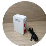
Le FM442p-n est un capteur IoT plug-and-play conçu pour surveiller la consommation d'énergie dans tous les types de bâtiments. Il peut être connecté à tous les types de compteurs dotés d'une sortie à impulsions (eau, gaz, chaleur, électricité). Le modem NB-IoT/LTE-M se connecte via les réseaux cellulaires standard. Les données de mesure sont transmises à un MQTT Broker et peuvent être récupérées par n'importe quelle solution de gestion des données énergétiques (SME).
