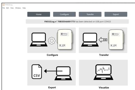
Le **logiciel FM332Log\_App** permet de transférer les données depuis le FM332Log vers un PC via un câble USB spécifique fourni (câble FTDI).
