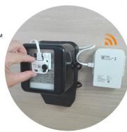
**BelSenso FM432e** est un dispositif universel de télé-relève des compteurs électriques. S'interfaisant avec le **réseau bas débit LoRa**, il permet en quelques minutes d'installation d'être informé sur son niveau de consommation d'électricité. Une solution incontournable pour généraliser le suivi des consommations électriques pour les petits et moyens bâtiments.
