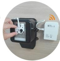
BelSenso FM432ir est un capteur optique IoT universel compatible avec la plupart des compteurs d'électricité. Il est spécialement adapté à la relève des informations délivrées par un port de communication infrarouge mais fonctionne également sur les vieux compteurs Ferraris (électromécaniques). La transmission des données est basée sur la technologie LoRa et est compatible avec tous les réseaux LoRaWAN.
