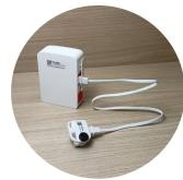
Le **FM442e** est un capteur IoT plug-and-play conçu pour surveiller la consommation d'électricité dans tous les types de bâtiments. La tête optique peut être rapidement fixée au compteur électrique principal ou à un sous-compteur, et le modem NB-IoT/LTE-M se connecte via les réseaux cellulaires standard. Les données de mesure sont transmises à un MQTT Broker et peuvent être récupérées par n'importe quelle solution de gestion des données énergétiques (SME).
